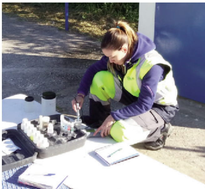
Figura 3. Trabajos de campo para el seguimiento hidrogeoquímico de los acuíferos
