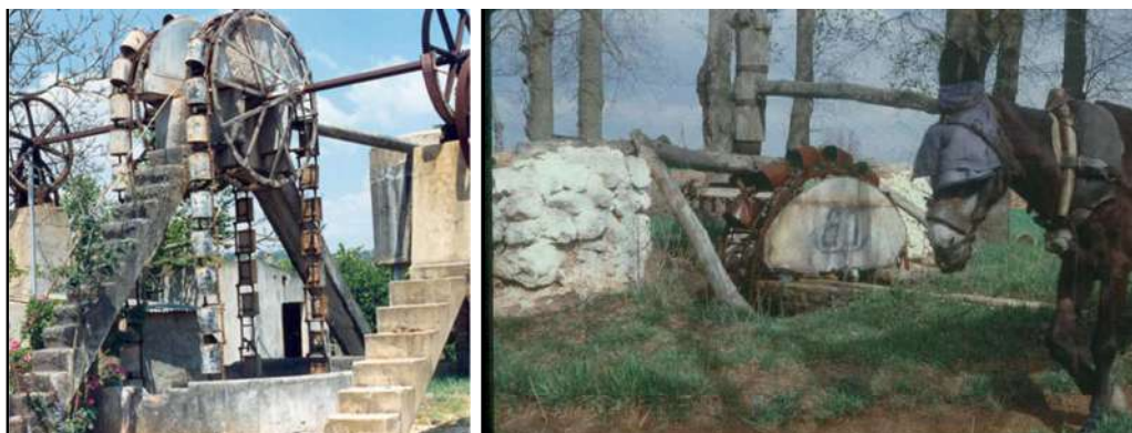
Foto 7. Las norias movidas por el hombre o por animales era el sistema más común de extracción de aguas.
